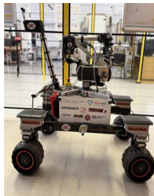
Experimentální mobilní robotická platforma pro servisní aplikace – Rover K3P4
