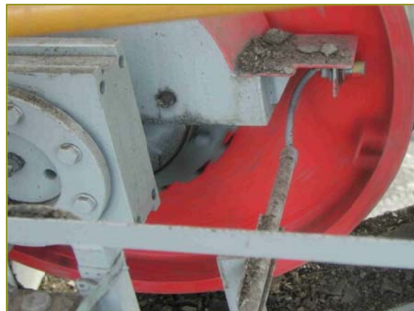
Pravá strana bubnu nevykazuje žádné tepelné anomálie
