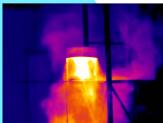
Obr.20 Aerosolový hasicí generátor „GABAR - P“ před a po výbuchu
