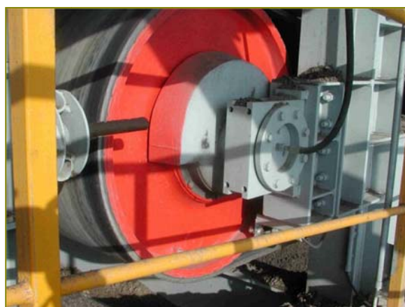
Levá strana bubnu se zvýšenou teplotou
