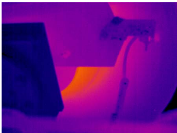
Pravá strana bubnu nevykazuje žádné tepelné anomálie
