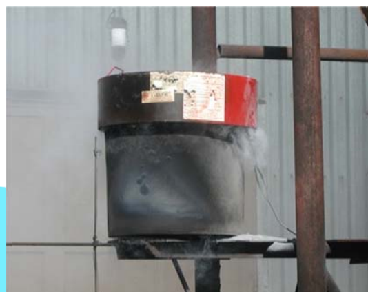
Obr.20 Aerosolový hasicí generátor „GABAR - P“ před a po výbuchu
