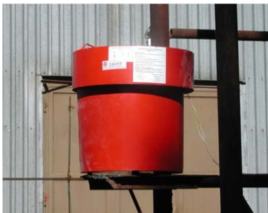
Obr.20 Aerosolový hasicí generátor „GABAR - P“ před a po výbuchu
