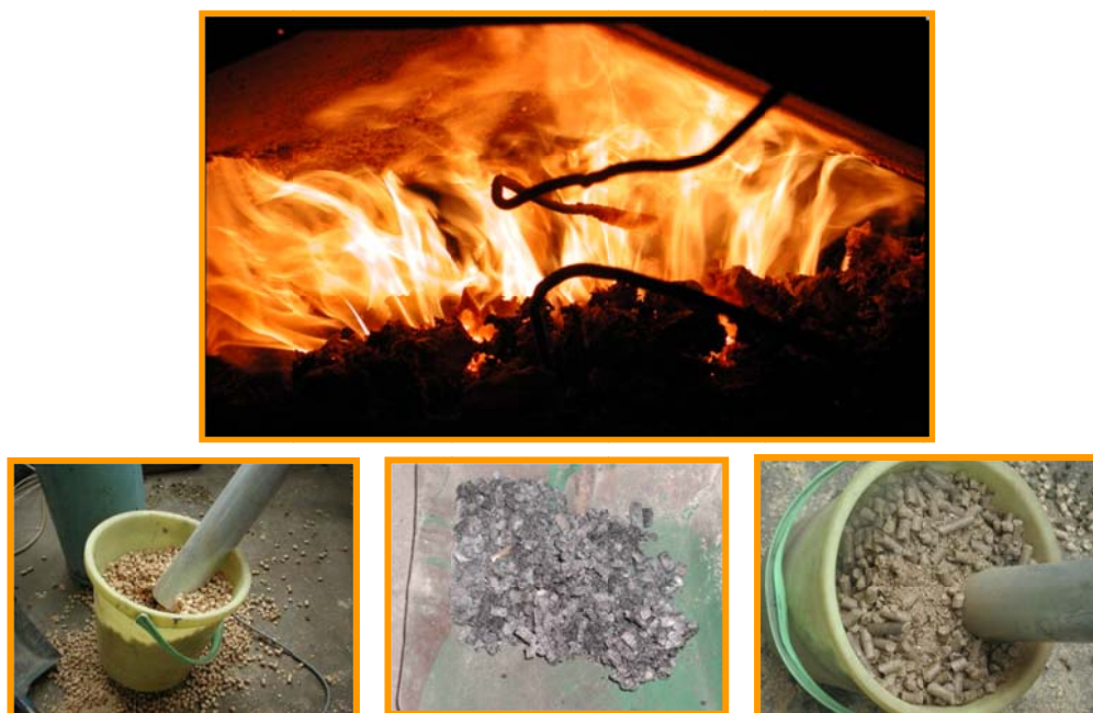
Obr.24 Přípravené vzorky neuhelných pelet určené pro laboratorní spalovací zkoušky při různých teplotách
