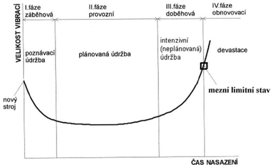
Obr. 25 Časový průběh vibrací v průběhu technického života - VANOVÁ KŘIVKA
