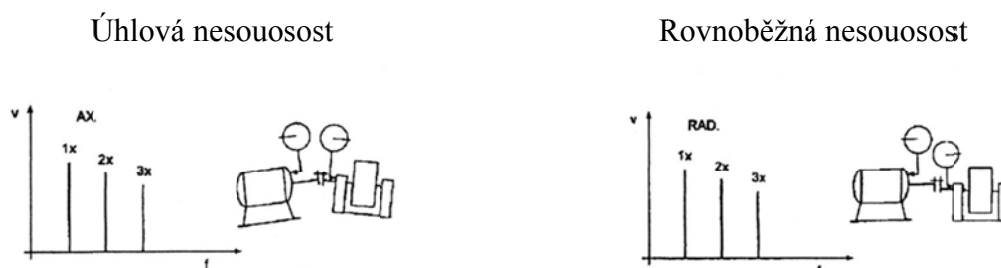
Obr. 39 Projevy nesouososti ve frekvenčním spektru
