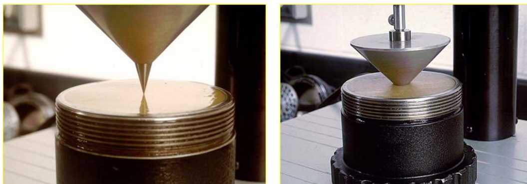
Obr. 12 Ukázka penetrační zkoušky dle ASTM D 217: kuželová penetrace plastických maziv
