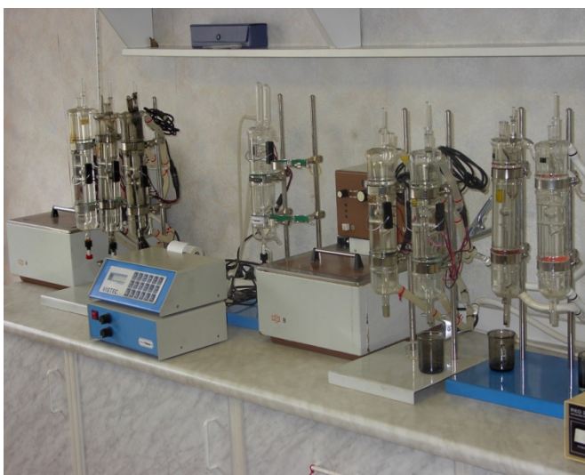
Obr. 1 Viskozimetr Ubbelohde a měření viskozity
