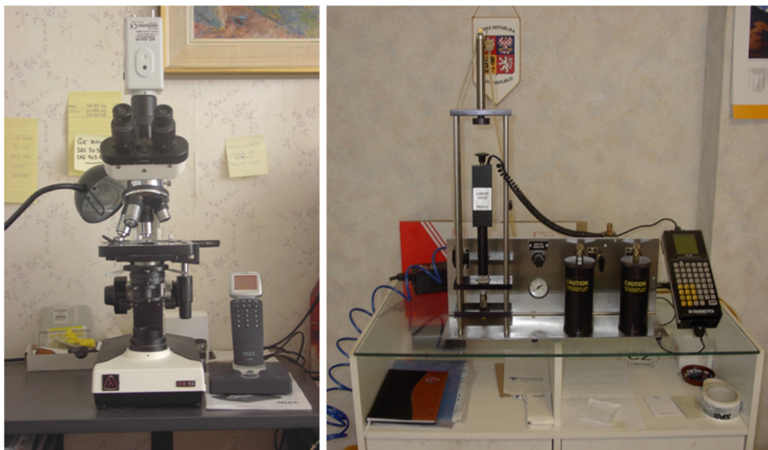
Obr. 7 Stanovení počtu částic mikroskopicky a automatickým čítačem
