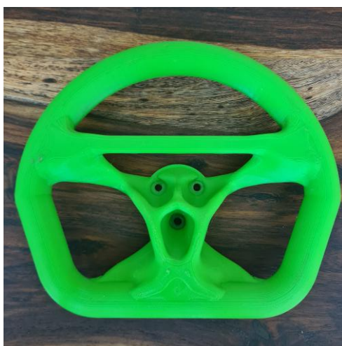
Obrázok 7 Optimalizovaný volant vytvorený aditívnou výrobou 75% výplň materiálu ASA
