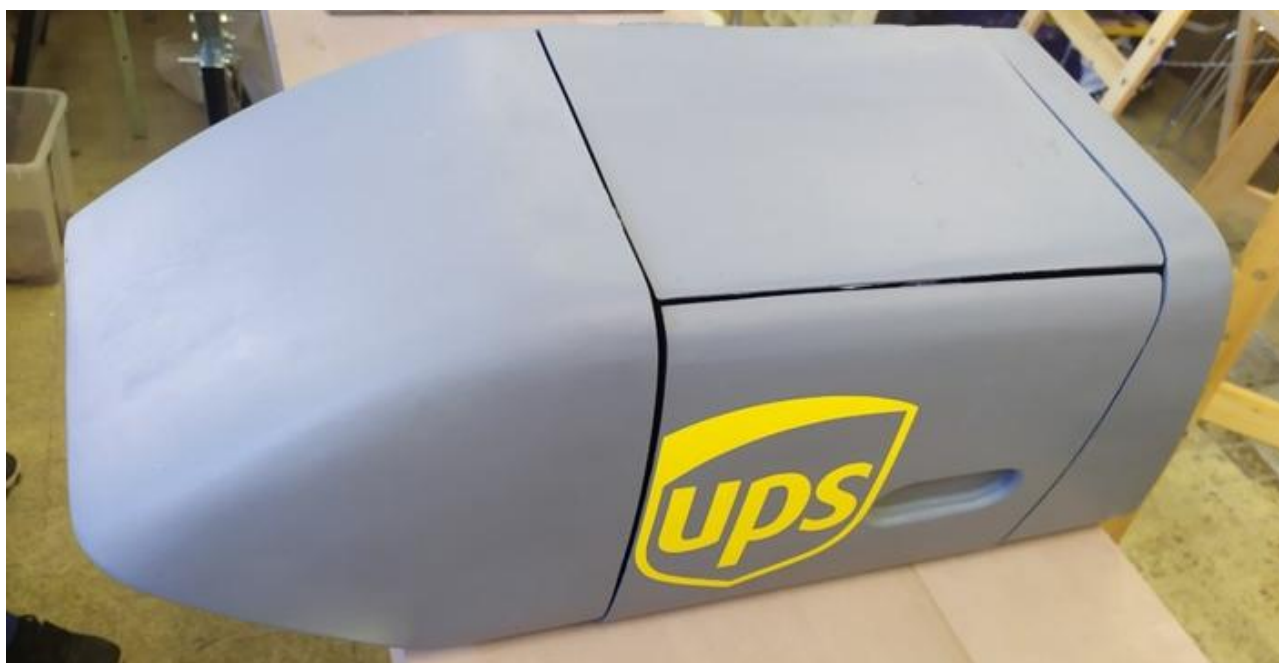
Obrázek 3 – Hotový model kufru z laminátu (zdroj – vlastní archiv)
