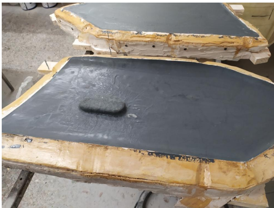
Obrázek 2 – Vyschlá první vrstva s oříznutými okraji (zdroj – vlastní archiv)
