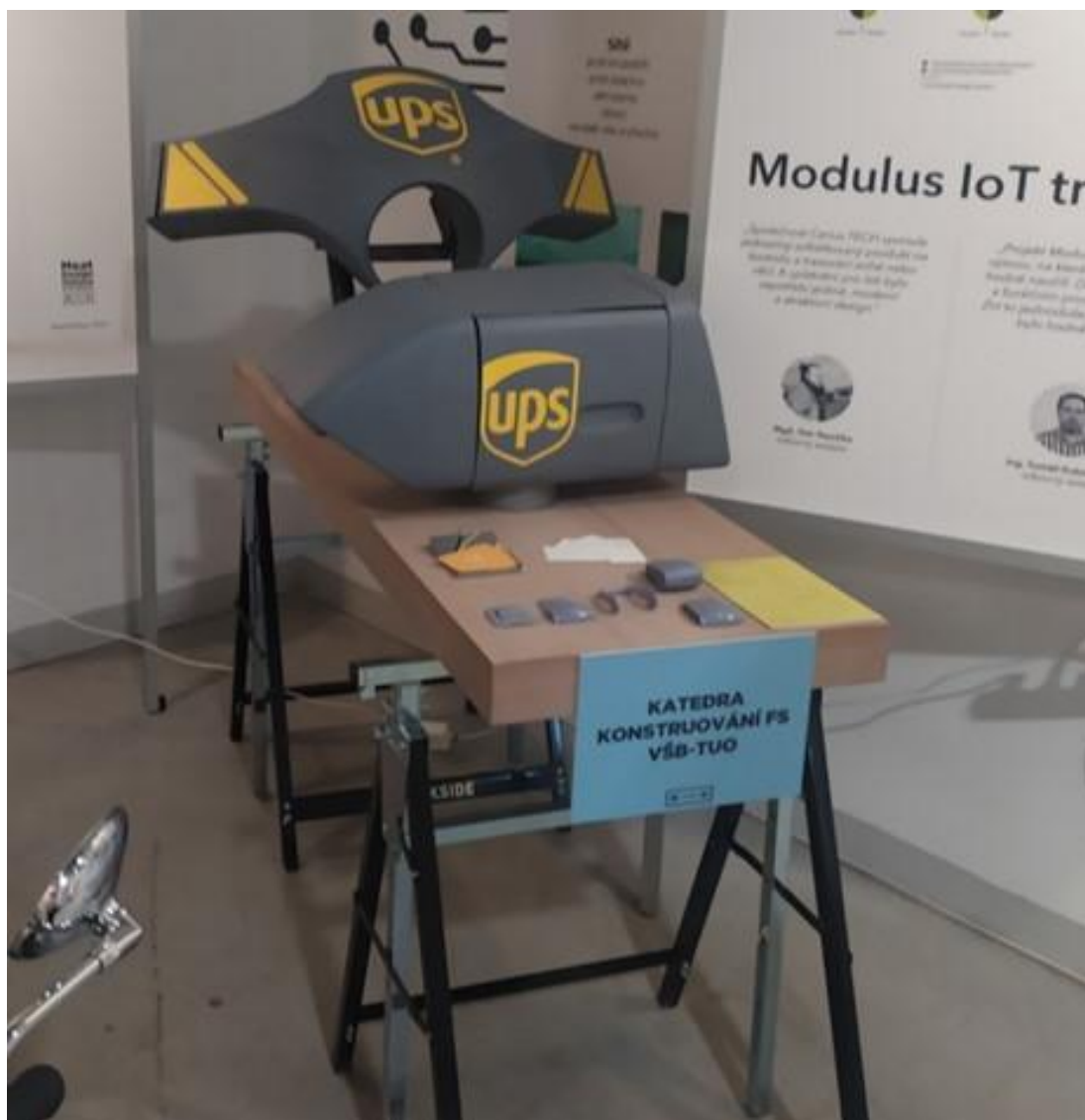
Obrázek 9 – Model kufru a kapotáže s 3D tištěnými částmi GPS trackeru v popředí (zdroj – vlastní archiv)
