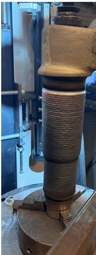
Obrázek 5 – Fotografie z procesu navařování
