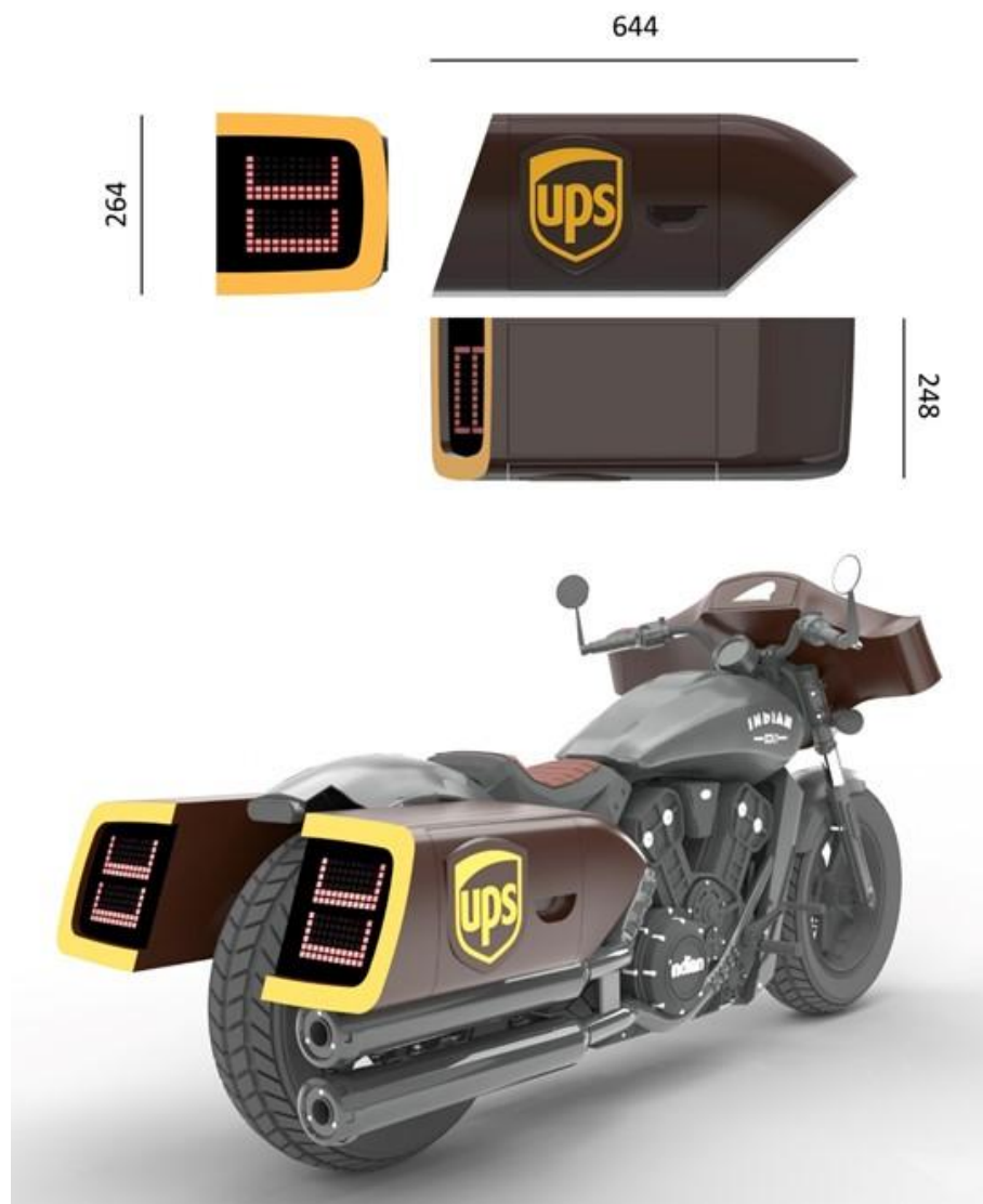
Obrázek 4 – RUV – rozměry a vizualizace kufru na motocyklu (zdroj – vlastní archiv)
