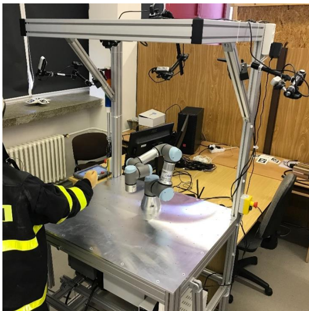
Obr. 3.9: Detekce překážek na pracovišti s kolaborativním robotem, vlevo – reálné pracoviště s překážkami, vpravo – vizualizace překážek (žluté boxy)
