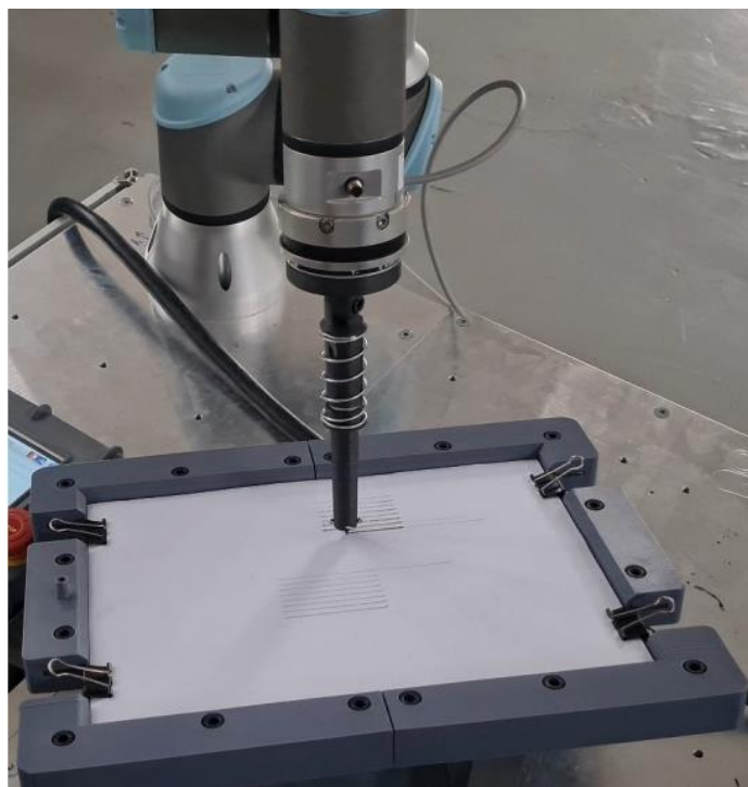
Obr. 3.13: Kreslení robotem UR3 – Realizace efektoru a SW pro zpracování fotografie a plánování pohybů robotu
