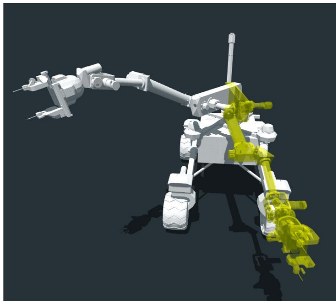
Obr. 3.12: Úprava manipulátoru roveru K3P4 a jeho ovládání
