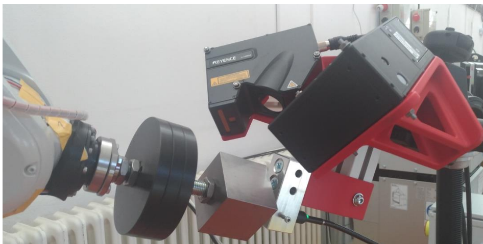
Obr. 6.3: Měřicí hnízdo. Robot s definovanou zátěží v podobě měřicí krychle se přibližuje ke konfokálnímu senzoru, který měří vzdálenost osy Z TCP. TCP X a Y jsou měřeny dvojicí liniových scannerů nad měřicí krychlí
