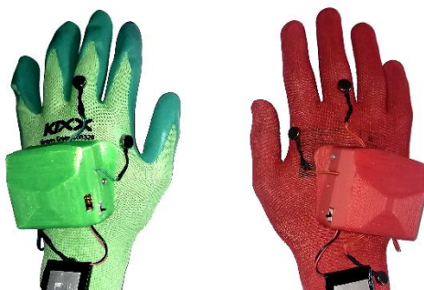
Obr. 6.10: Prototyp oznamovacích zařízení. Každá rukavice je vybavena šesti vibračními motory, které poskytují haptickou zpětnou vazbu
