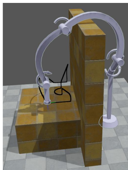
Obr. 6.22: Příklad navržené obecné optimální kinematické struktury se zakřivenými rameny
