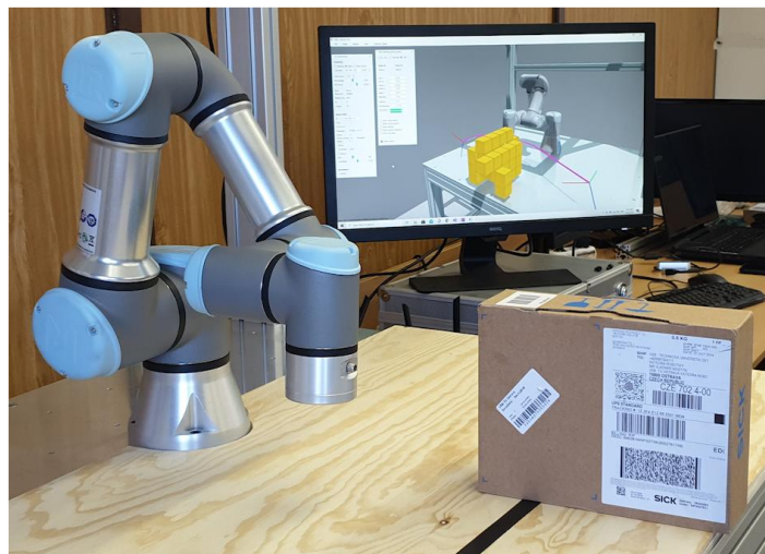
Obr. 6.20: Praktické testování algoritmu vyhýbání se překážkám pomocí pomyslné gumy, v popředí skutečné pracoviště s překážkou (krabice), v pozadí řídicí systém s 3D real-time vizualizací
