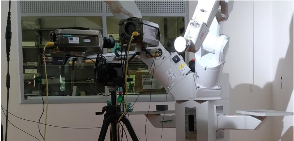
Obr. Použití DIC kamer DANTEC při měření opakovatelnosti manipulátoru
