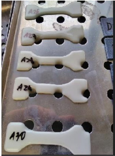
Obr. Roztečené vzorky po žihání (nalevo), tahový diagram pro různé teploty žihání (napravo)
