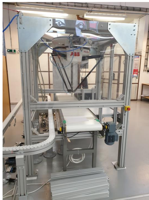
Obr. Robotizované pracoviště s robotem ABB IRB360, dopravníky a systémem strojového vidění
