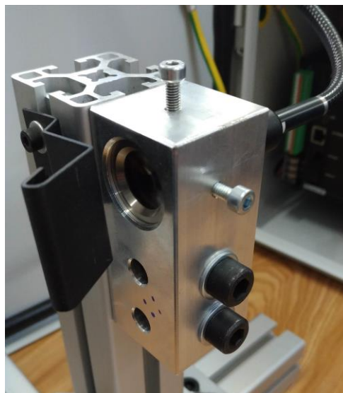
Obr. Konfokální měřicí systém – vyhodnocovací jednotka a senzor v montážním držáku
