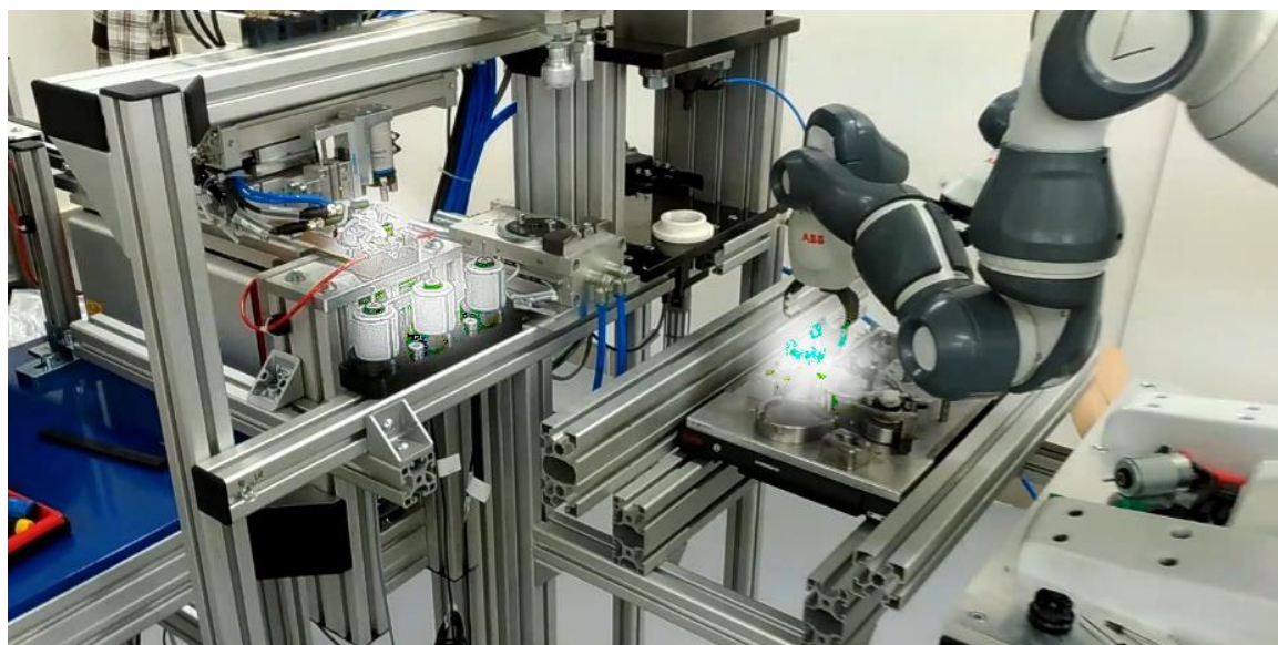
Obr. Montážní stanice s kolaborativním robotem YuMi
