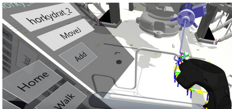
Obr. Ukázka použití ovladače systému VR pro programování pohybu robotu
