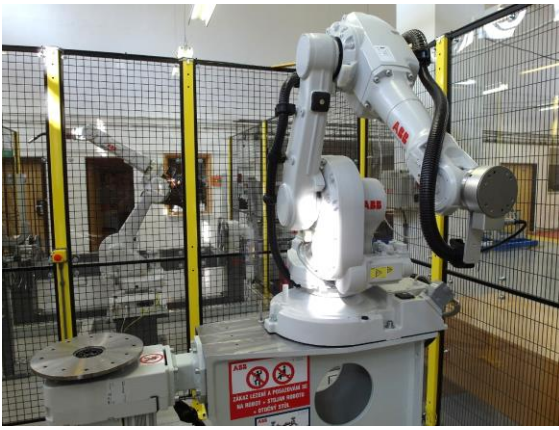
Obr. Obráběcí robotizované pracoviště s robotem IRB 1600
