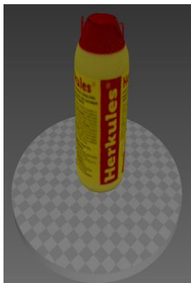
3D model získaný za pomoci 3D laserového skeneru
