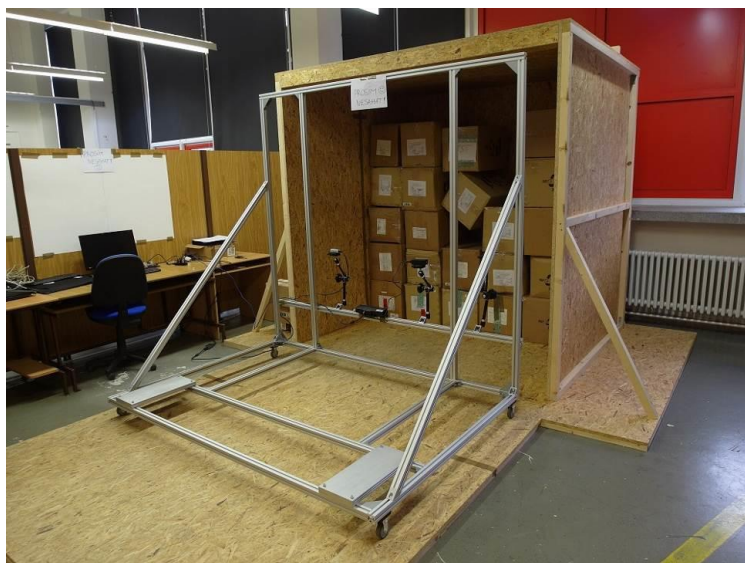
Obr. Zkušební stand pro testování senzorů (3D kamer)
