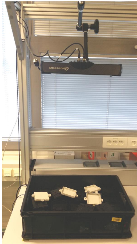
Obr. Testování systému BinPicking (3D scanner) od PhotoNeo
