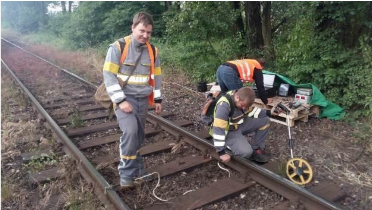
Obr. Foto z měření impedance kolejového vedení a kalibrace zařízení AXIO - systém pro měření vzdálenosti a rychlosti drážních vozidel.
