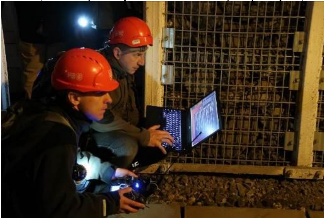
Obr. Testy 3D skeneru na mobilní platformě v dole
