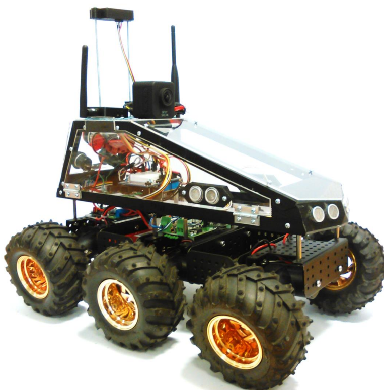
Obr. MR Viper schopný autonomní jízdy přes zadané GPS souřadnice
