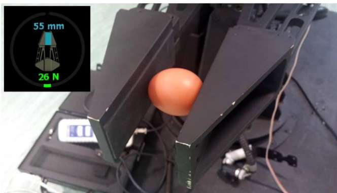
Obr. Testy řízení síly stisku ramene – zvládne bezpečně uchopit a manipulovat se syrovým vejcem, stejně i s 20 kg nástražným systémem
