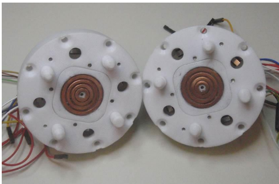
Obr. Inteligentní spojovací systém ve verzi 3.0.8 (plast, rapid prototyping)
