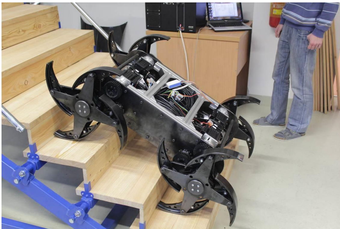
Obr. Testovací jízdy podvozku se speciálními koly po schodech
