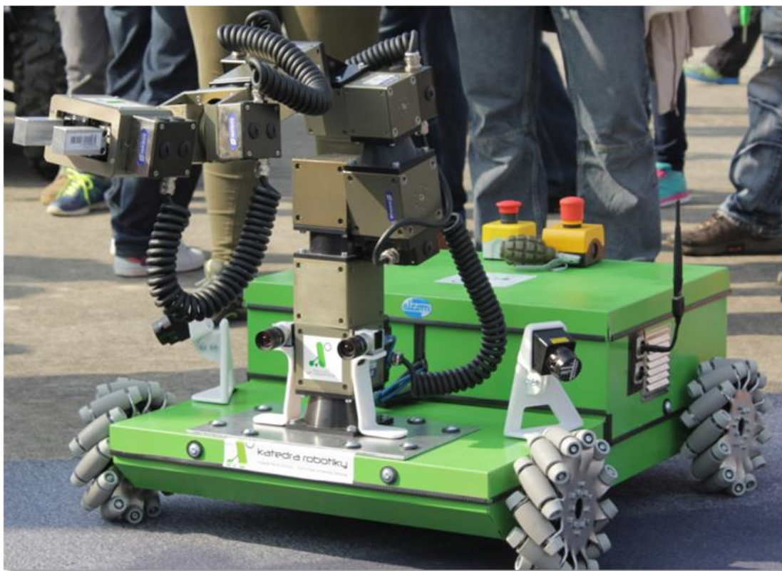
Obr. Robot ODIN se směrovými koly a osazený modulárním manipulačním ramenem, stereovizí a dvojicí 2D laserových skenerů.
