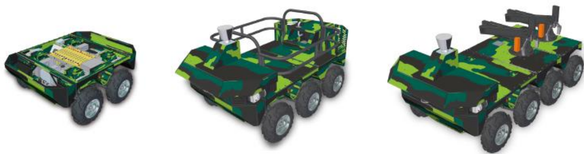
Obr. Základní modul TAROS V2 s možnými přídatnými moduly – úplně vpravo varianta s manipulačními rameny
