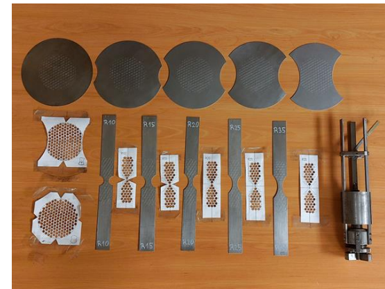
Nástroje a vzorky pro zkoušky tvárnosti plechu
