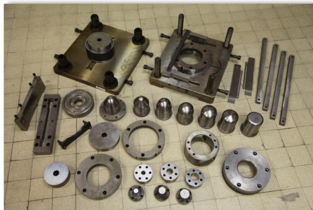
Nástroje a vzorky pro zkoušky tvárnosti plechu
