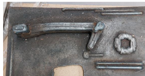
Navařování páky metodou WAAM
