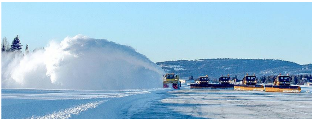
Obrázek 9.4 Odstraňování sněhu z RWY (Zdroj: overaasen.no)
