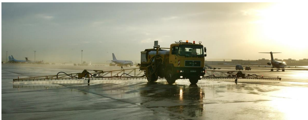
Obrázek 9.5 Aplikace odmrazovací kapaliny na provozní plochy (Zdroj: basf.com)
