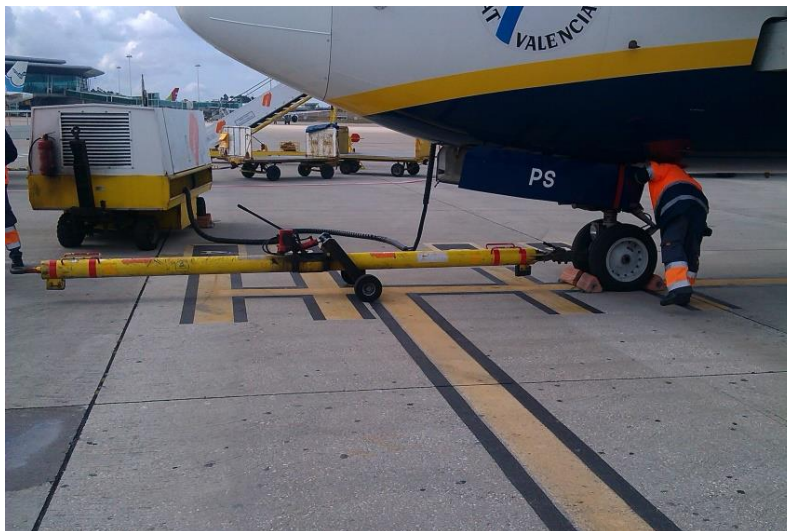
Obrázek 8.6 Pozemní zdroj GPU a oj na vytlačení letadla (Zdroj: autor)
