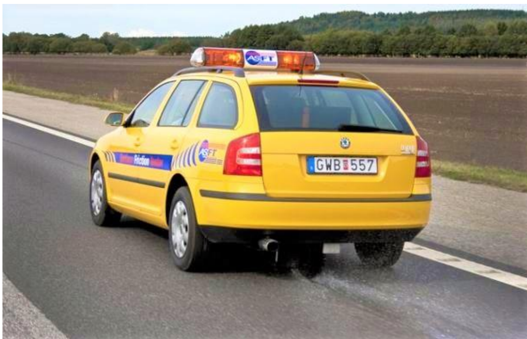
Obrázek 9.6 Měření brzdných účinků vozem Škoda-Sarsys (Zdroj: Sarsys)
