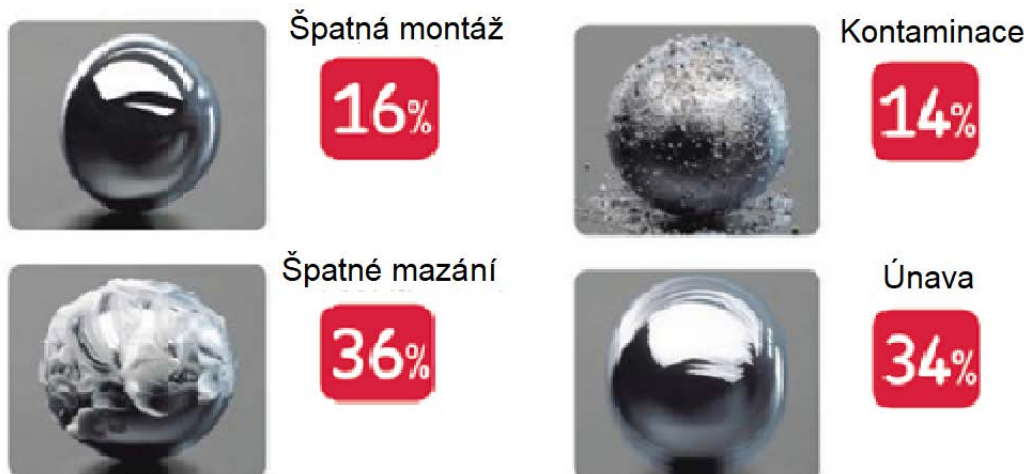
Obr.1 Příčiny selhávání ložisek dle odhadů SKF
