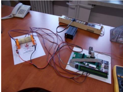
Stanowisko do badania rozkładu temperatury na obudowie ogniwa podczas rozładowania
