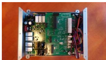
Kontroler ogniw z balansowaniem aktywnym metodą bateria do ogniwa
