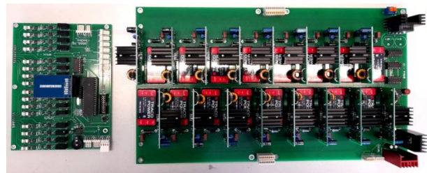
Kontroler ogniw z balansowaniem aktywnym metodą bateria do ogniwa
