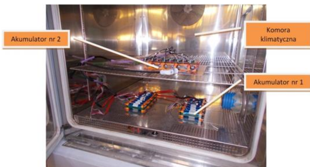
Kontroler ogniw z balansowaniem aktywnym metodą bateria do ogniwa
