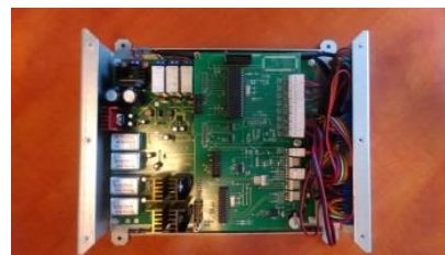
Kontroler ogniw z balansowaniem aktywnym metodą baterii do ogniwa
