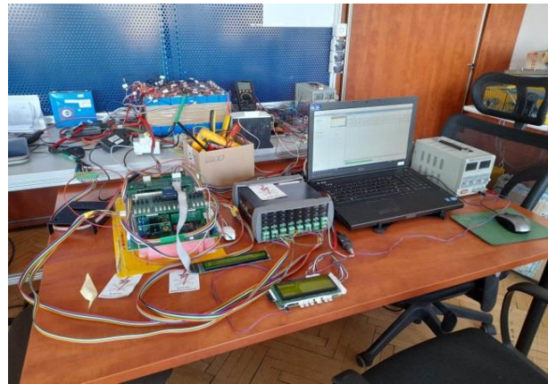
Stanowisko badawcze dla prób rozładowania i balansowania akumulatora używanego podwieszonym ciągniku akumulatorowym PCA-1 podłączonego do aktywnego systemu BMS
