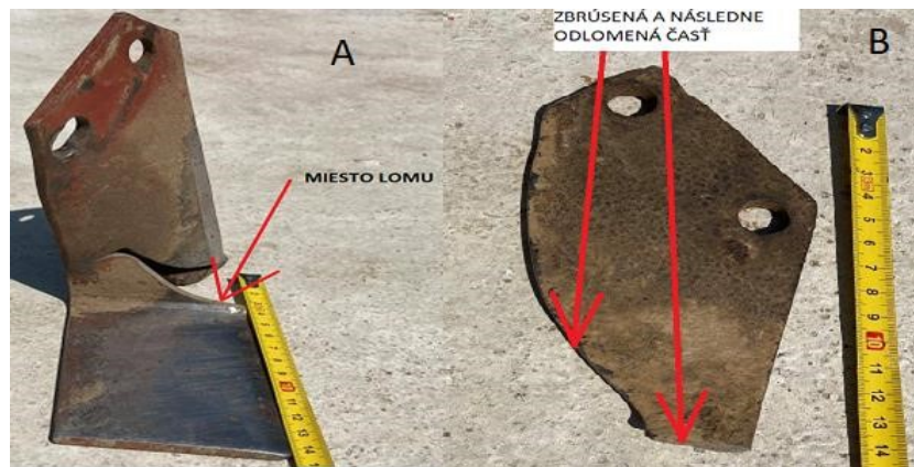
Obr. 1 Poškodenie nožov (Baloga, 2021)
