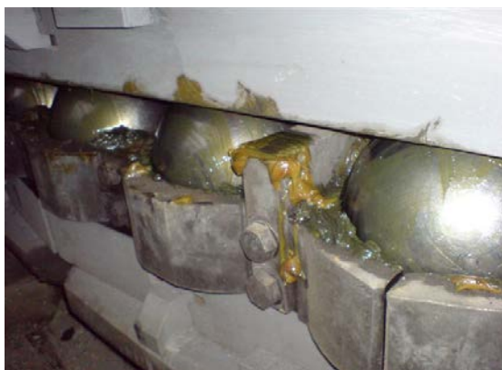
Obrázek 9 - Nové mazivo kulové dráhy
