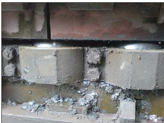
Obrázek 8 - Detail kulové dráhy původní mazivo
