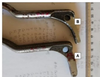
Figure 2 Detail povrchu a místo měření chemického složení metodou ED-XRF
