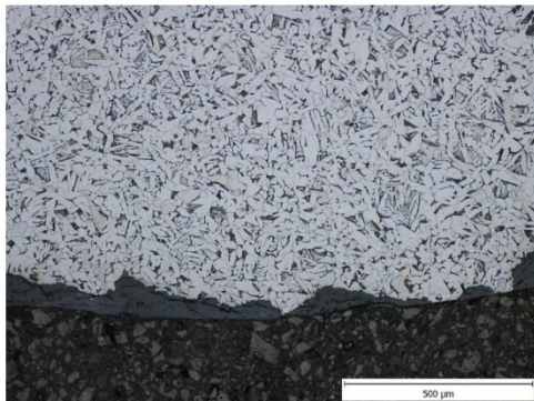
Figure 5 Mikrostruktúra dveřní kliky D, povrch s korozi, lepané v Nitalu (LM)
