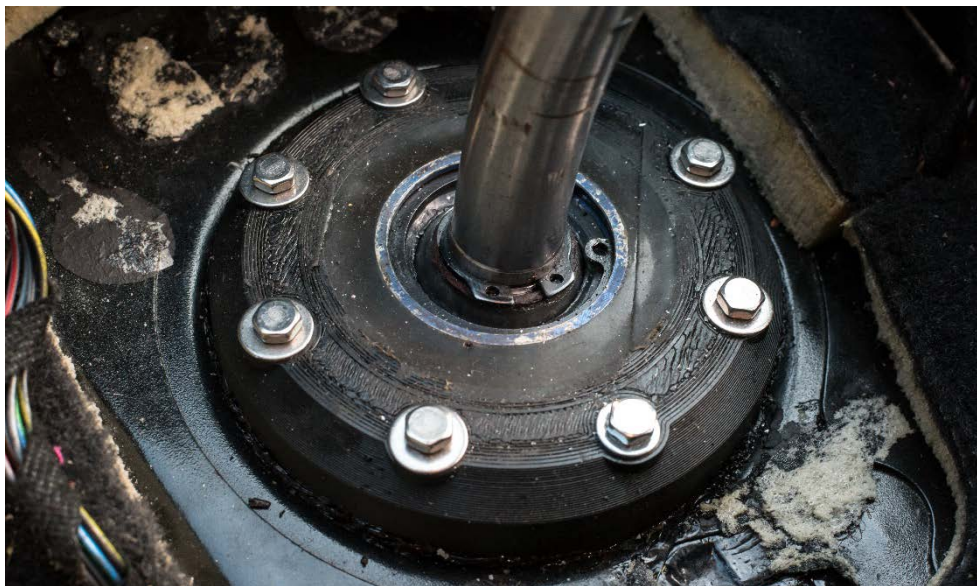
Obr. 7 – výsledný silentblok namontovaný v automobilu.
