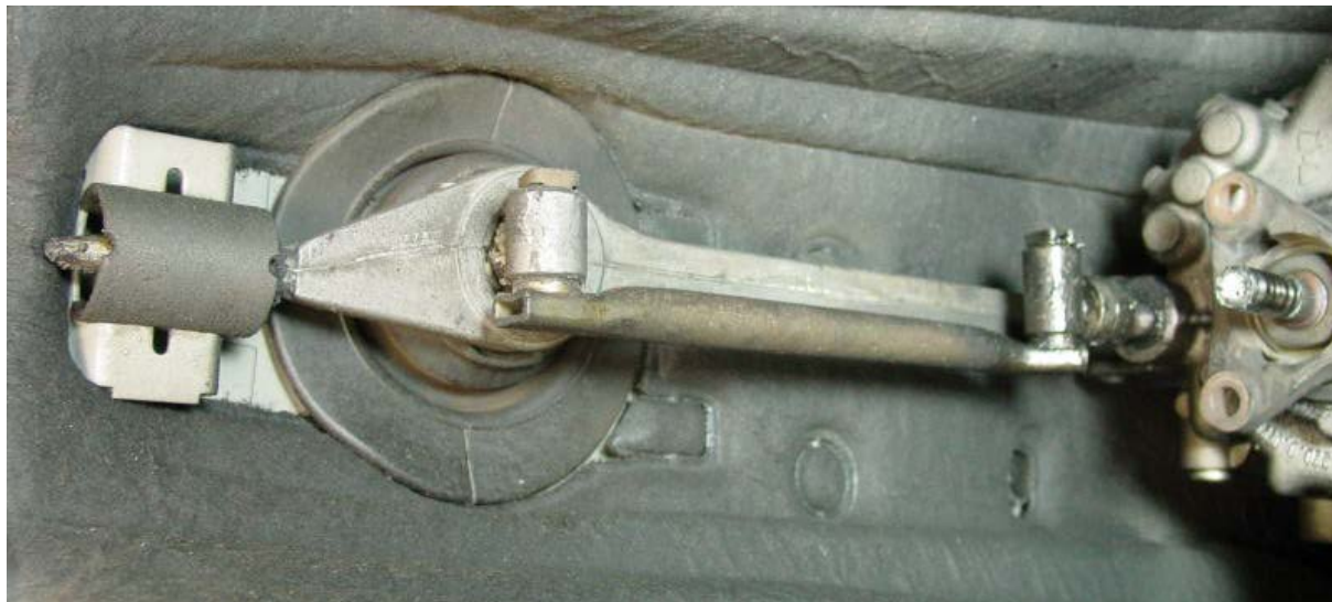
Obr. 2 – originální uložení řadicí páky.
