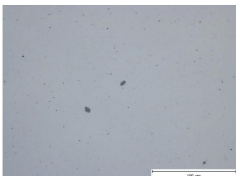
Figure 9 Dveřní klika D, vyleštěný stav, inkluze
