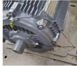
NDS u hřídele (bez ventilátoru) - Horizontálně - Rychlost Vef = 0,837 mm/s
