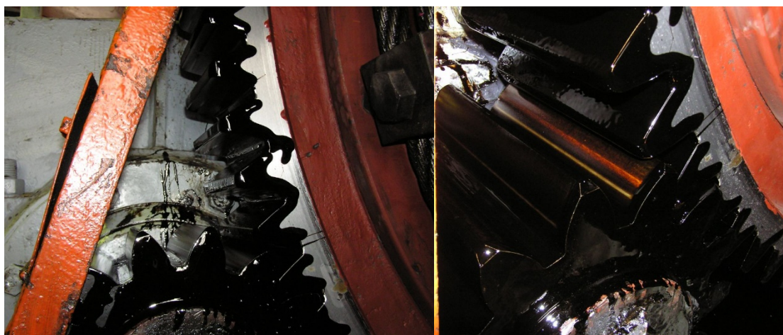
Obrázek 5 - Mazání otevřeného ozubeného převodu asfaltickým mazivem CARTER ENS/EP 700
