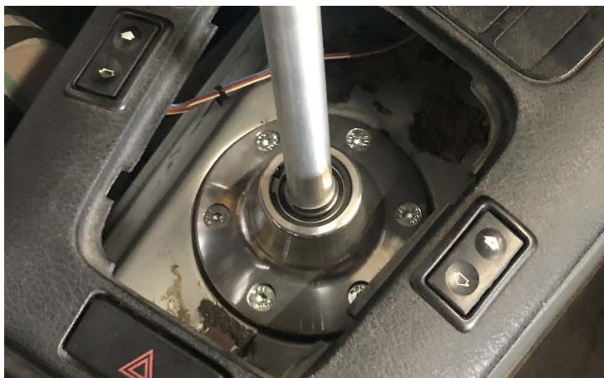
Obr. 4 – přímá montáž řadící páky ke karoserii automobilu. Kovové pouzdro ovšem přenáší všechny rázy přímo do karoserie.
