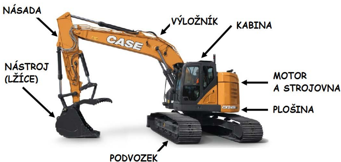
Obr. 6. - Hlavní části hydraulického rýpadla [5]
