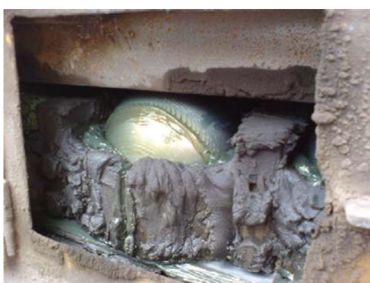
Obrázek 10 - Stav dráhy s novým mazivem
