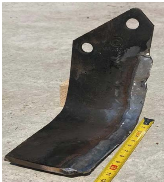
Obr. 5 Nôž po navarení a obrúsení (Baloga, 2021)
