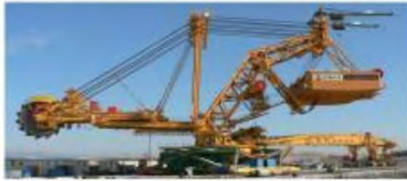
KU 800 - Kolesové rýpadlo, výkonost 5000 \text{ m}^3 \cdot \text{z} \cdot \text{h}^{-1} , hmotnost 4420 tun.
