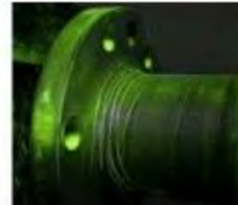
Obr. 6: Trhliny nalezené pomocí MT kontroly Zdroj: https://www.tech-nh.com/magnetic-particle-inspection/
