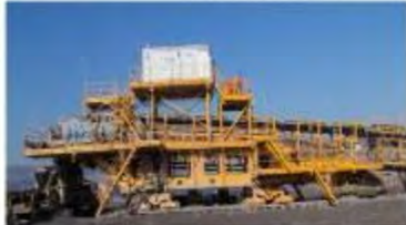
Poháněcí stanice DPD, šíře dopr. pasu 1800 mm. Celková délka DPD cca 10 km.
