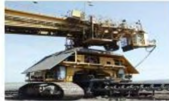
DS-OH - Drtič skřívky obkročný housenicový, výkonost 5000 \text{ m}^3 \cdot \text{z} \cdot \text{h}^{-1} , hmotnost 210 tun.
