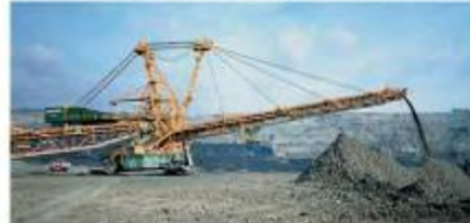
ZP 6600 - Zakladač výkonost 6600 \text{ m}^3 \cdot \text{z} \cdot \text{h}^{-1} , hmotnost 1800 tun.
