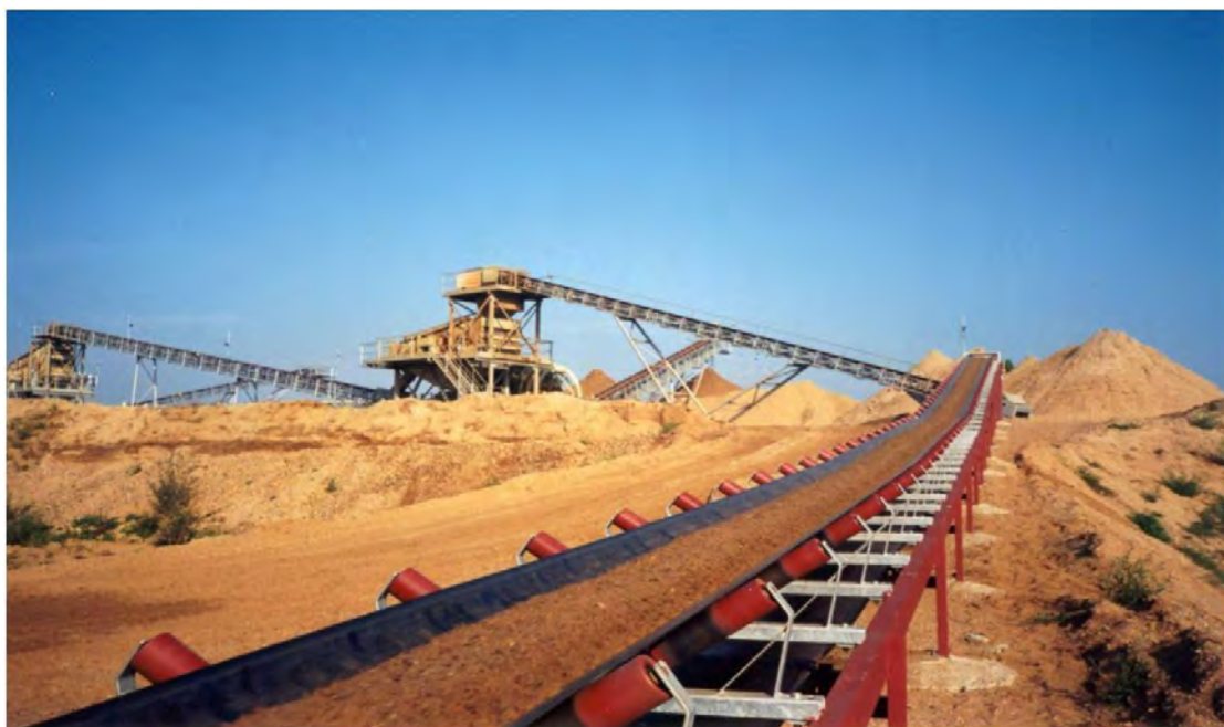
Obrázek č. 1 Dálková pásová doprava na povrchovém dole [4]
