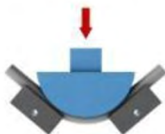
OHYB POD LISEM (Press or Ram Bending)
