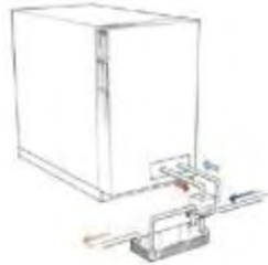
Tepelná výměna u vzduchem chlazeného, olejem mazaného kompresoru
