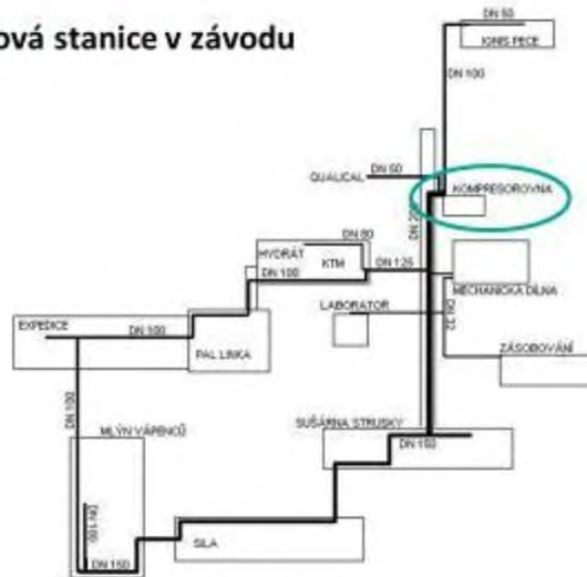
Rozvod stlačeného vzduchu
