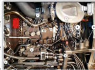
Obr. 1. Boroskopické zátka motoru CFM 56-5 [1]
