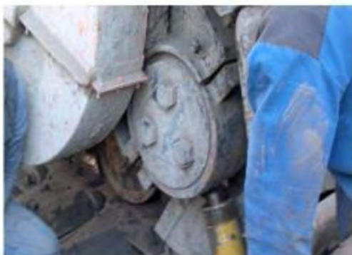
Roztržená pánev uložení hřídele turasu.
