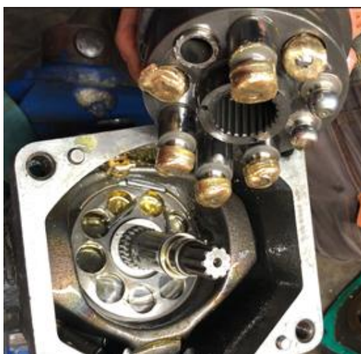
Obr. 2.4 Poškození axiálního pístového hydrogenerátoru vlivem snížené mazací schopnosti kapaliny
