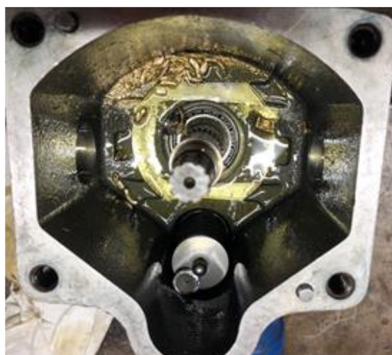
Obr. 2.4 Poškození axiálního pístového hydrogenerátoru vlivem snížené mazací schopnosti kapaliny
