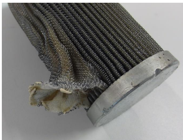
Obr. 4.13 Nízkotlaký filtr s opticko-elektrickým indikátorem znečištění filtrační vložky (vlevo), poškození filtrační vložky při nesprávné montáži (zapojení) filtru (vpravo)
