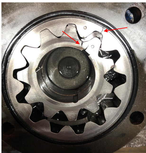
Obr. 4.5 Příklad poškození vlivem nečistot v hydraulickém systému u zubového hydrogenerátoru s vnitřním ozubením
