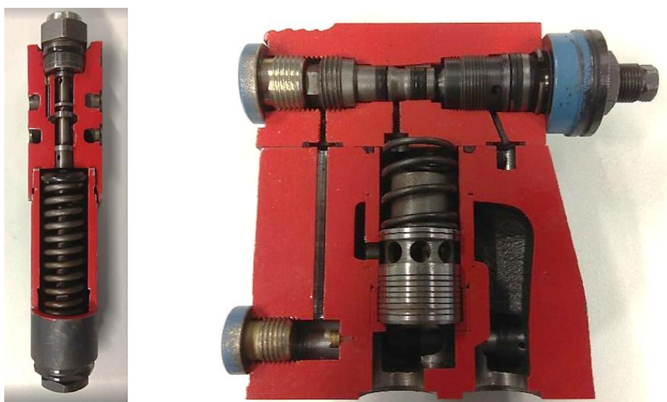
Obr. 9.10 Přímě řízený redukční ventil sedlové konstrukce (vlevo), nepřímě řízený redukční ventil sedlové konstrukce (vpravo)
