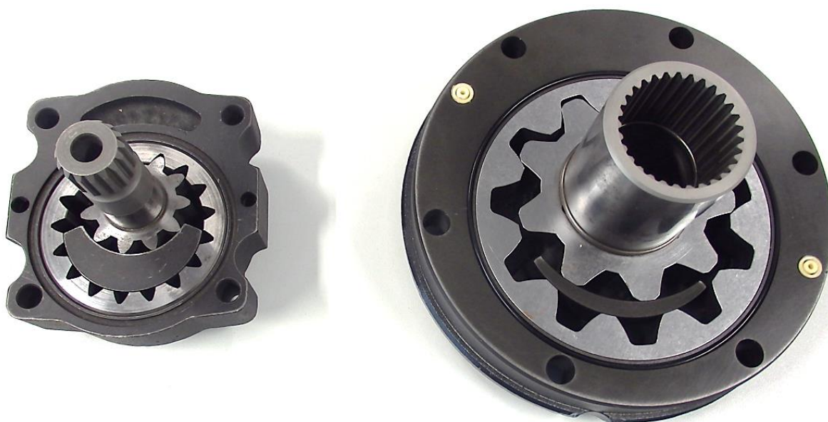
Obr. 5.13 Ukázka zubových hydrogenerátorů s vnitřním ozubením
